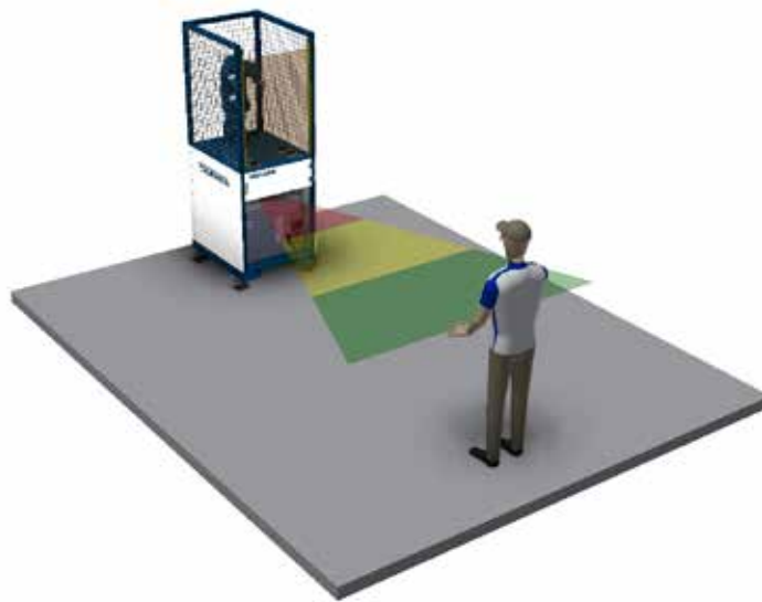
Simulación zonas de seguridad entre robot y operario
